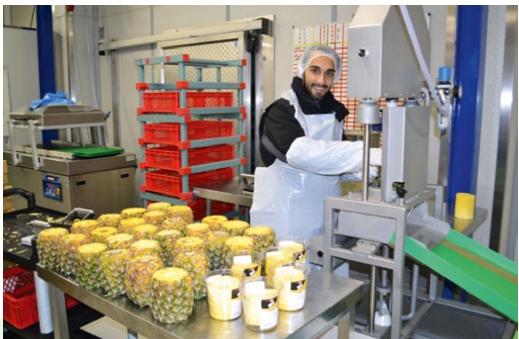
Eine Spezialmaschine hilft beim Schälen und Schneiden frischer Ananas. Auch die Reststücke werden genutzt: in der „Cuisine Artisanale“ von BIOGROS wandert ihr Saft in BIOG-„Slow Juices“.
